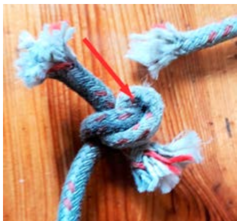
Figur 2: Den brustna lina i en Hunter's bend. Den röda pilen visar brottytan där lina kommer ut ur knopen.
